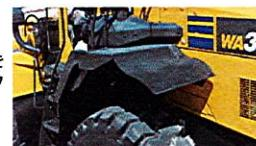
左リア部に、エンジン吸気部への泥はね防止を兼ねた、左サイドパネルを開閉しやすいハーフサイズのフェンダーを装備しました。
