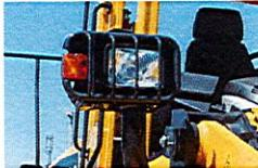
ライトプロテクタを設置した狭幅作業灯を採用。作業灯の損傷を防止します。
