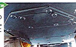
石の跳ね返りなどからトランミッションなどのパワートレーンを保護するアンダーカバーを装備。取付ボルトは突き上げなどによる破損を未然に防ぐように、プロテクタ付としました。
