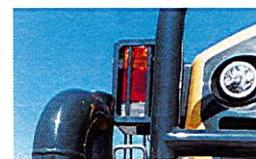
エンジン用ブリクリーナを標準装備。自動排出式を採用し、粉塵の多い切羽での作業に最適化しています。
